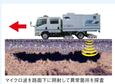
マイクロ波を路面下に照射して異常箇所を探査
