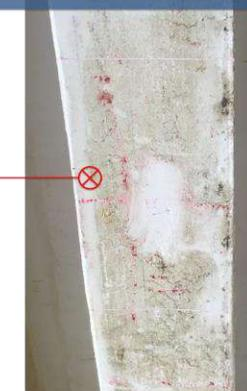
破断箇所も検知できているし、一番外側の1本素線破断も検知できていた。
