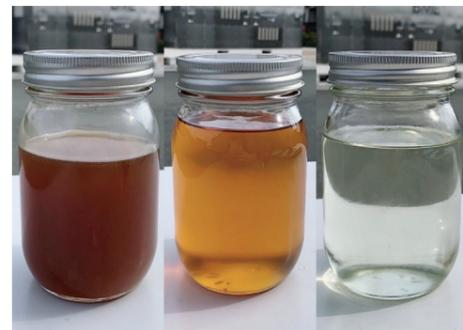
回収した廃油(左)と従来のBDF(中央)、さらに精製した高純度BDF(右)。高純度BDFは純度99.9%で、JAS-K2390の26項目すべてをクリアしている。
